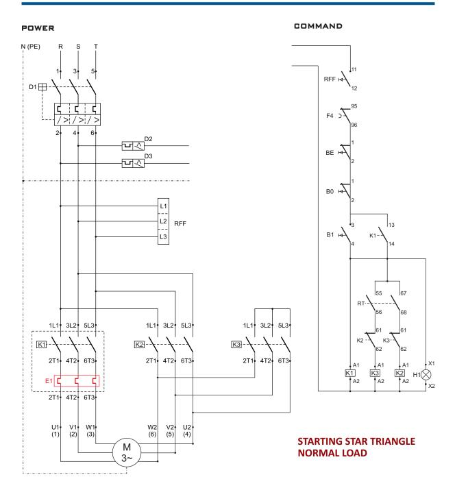
D1,D2,D3 - DisjuntoresRFF - Phase lack relayE1 - Overload relay
