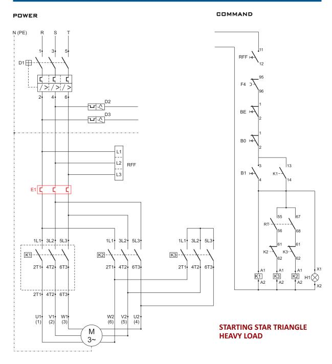
D1,D2,D3 - Disjuntores RFF - Phase lack relay
