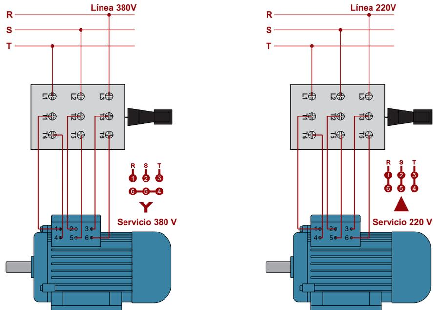
**- MOTOR DE 6 CABLES DE ENROLLAMIENTO 220/380 Y TENSIÓN DE SERVICIO 220V**
