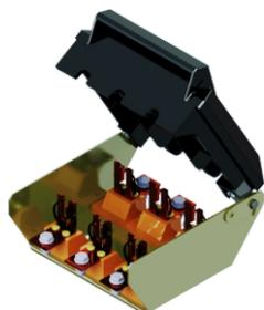
La llave de seccionamiento con tiene su mecanismo y contactos eléctricos diseñados para una interrupción de línea con o sin una corriente eléctrica circulante. Este tipo de llave está equipada con "cámara de extinción del arco eléctrico." Es un dispositivo de apertura de carga. Es el dispositivo más simple, que sólo es aplicable a los motores de baja potencia. El arco eléctrico que se produce en el cierre y apertura provoca un desgaste en los contactos.
